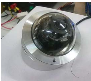
Valvontakamera väri,IR 15LED, kaapeli 18m Tuotenumero RV DCM93A
