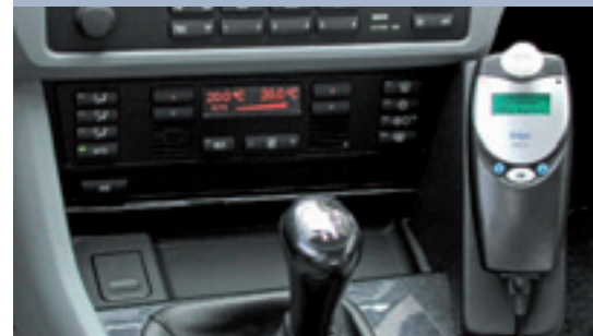
Dräger Interlock XT asennettuna kuljettajan paikalle
